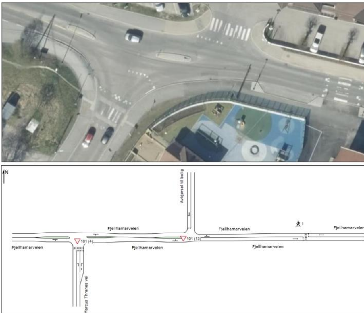
Figur 6-1: Kryssutforming fra flyfoto og fra modell i SIDRA Intersection eksisterende kryssutforming (Flyfoto fra kart.finn.no)
