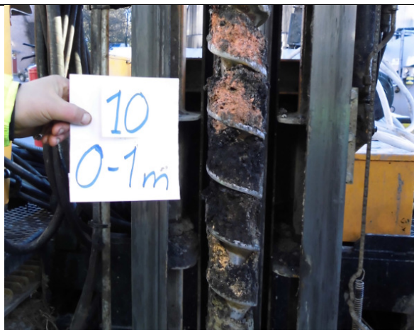
Foto 11. Masser fra punkt FM10, 0-1 m. Denne prøven inneholdt den høyeste oljekonsentrasjonen som er påvist i denne undersøkelsen (tilsvarende farlig avfall).
