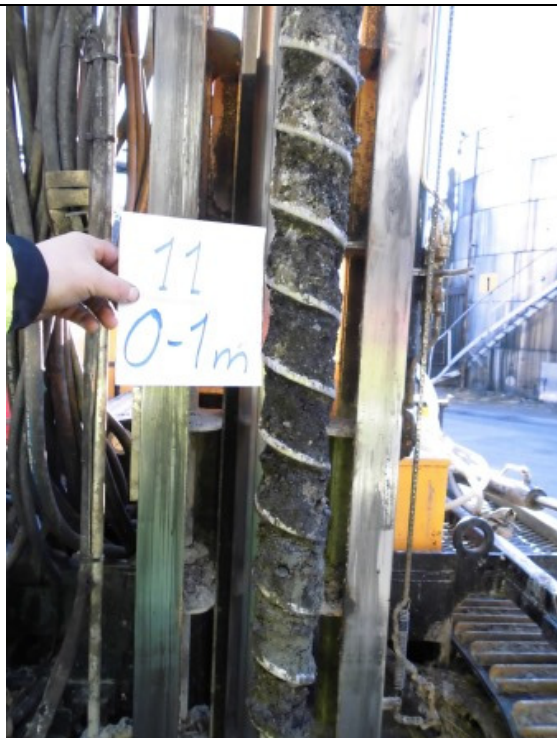
Foto 2. Masser fra punkt FM11, 0-1 m. Analyser viser konsentrasjoner som tilsvarer farlig avfall.
