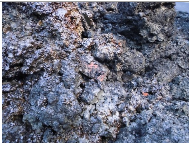
Foto 5. Fyllmasser fra sjakt FS1, med innblandet fri fase olje.
