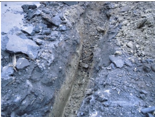
Foto 8. I sjakt FS2 ble det kun påvist et tynt lag (0,7 m) med fyllmasser oppå leire.
