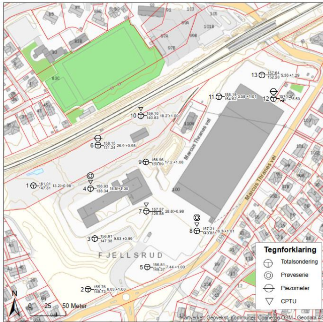
Figur 5: Utførte boringer i 2017 i regi av Golder.
