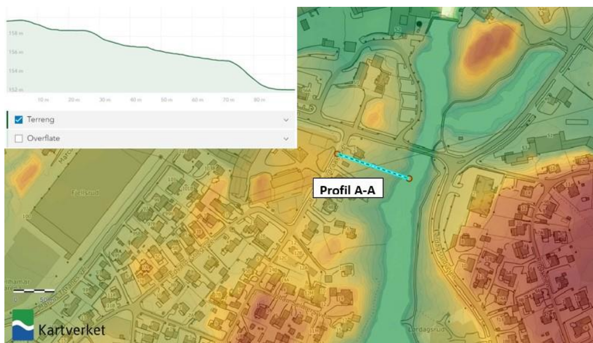
Figur 4: Skråningshelning for profil A-A. Kartutsnitt er hentet fra www.hoydedata.no
