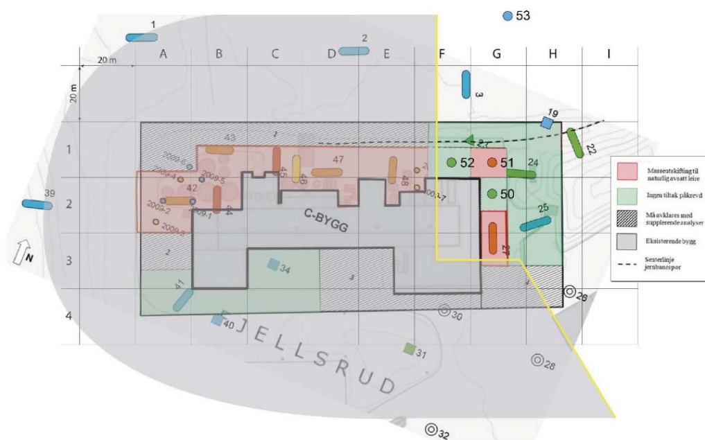
Figur 5 Masseutskifting og graveplan for området ved C-bygget.
